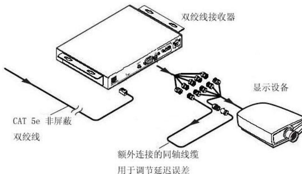
(图 7) 用同轴线对延迟误差作补偿。
